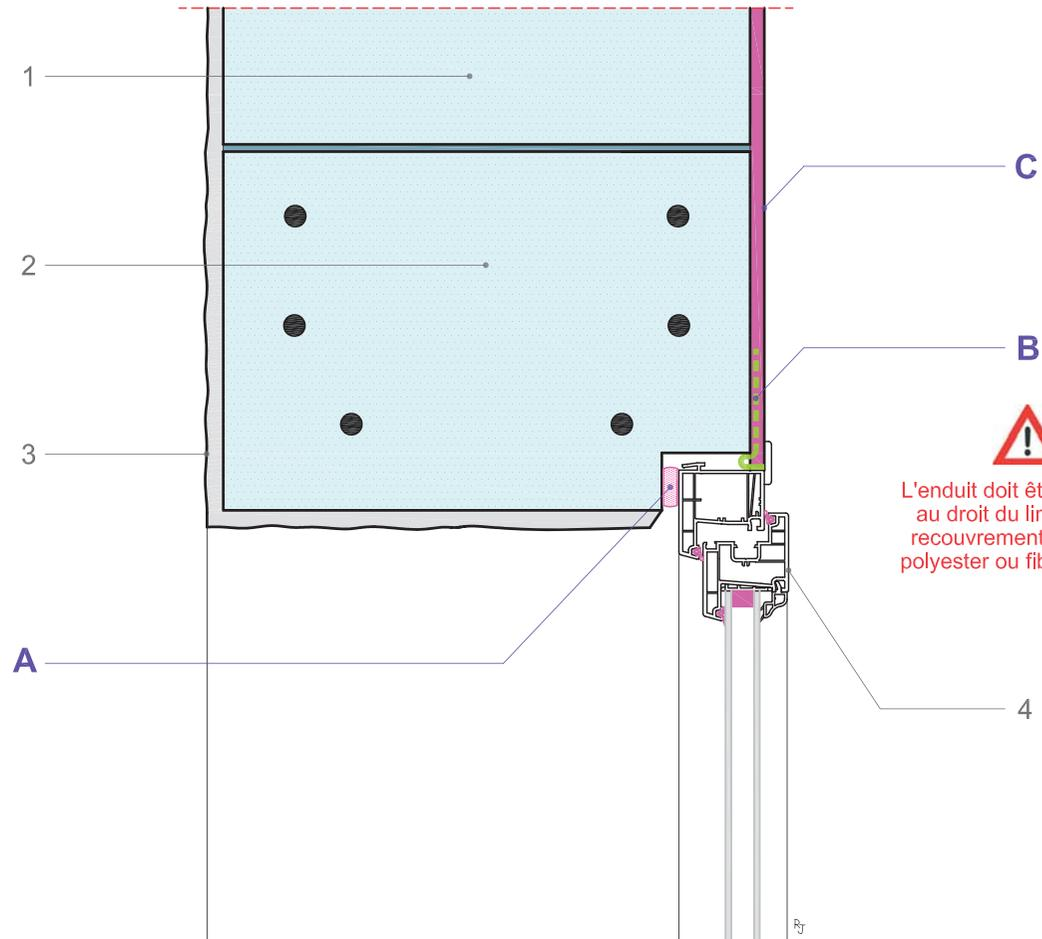
**L'enduit doit être prolongé au droit du linteau et en recouvrement de la grille polyester ou fibre de verre**
