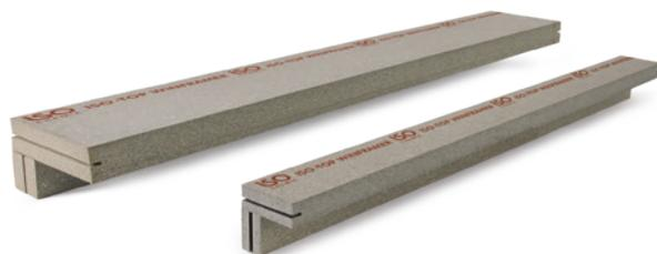
Das VORWANDMONTAGESYSTEM ISO-TOP WINFRAMER „TYP 1“ E30 wurde auf Basis des „TYP 1“ entwickelt. Durch den intumeszierenden Effekt des Werkstoffs PURATHERM E30 ist der ISO-TOP WINFRAMER „TYP 1“ E30 speziell für den Einsatz in Brandschutzfassaden konzipiert und erzeugt einen schützenden Bläheffekt bei großer Hitzeeinwirkung.
