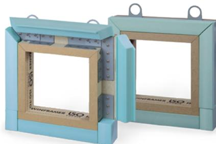
Das VORWANDMONTAGESYSTEM ISO-TOP WINFRAMER „TYP 1“ PREFAB besitzt alle technischen Vorteile des „TYP 1“. Die Auslieferung in individualisierbaren Auskragsdimensionen und objektbezogenen Lieferlängen ermöglicht eine Vorfertigung der Montagezarge mit vormontiertem Fensterelement als geschlossenes Rahmensystem im Betrieb.
