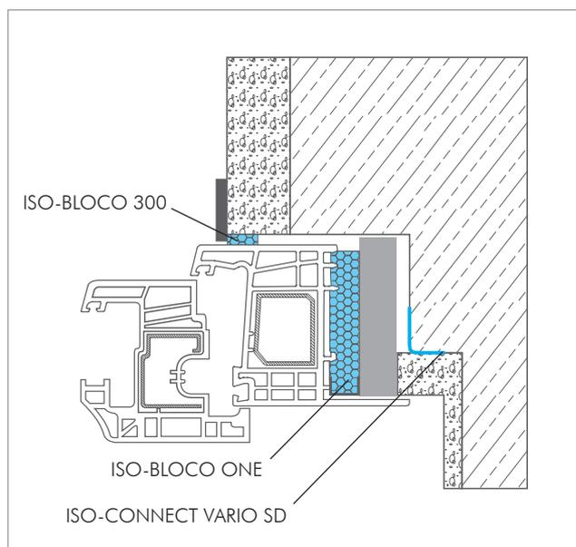
Esempio di installazione: ISO<sup>3</sup>-SISTEMA DI TENUTA PER FINESTRE
