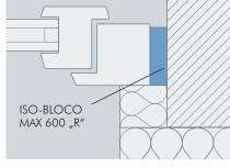
Exemple de mise en œuvre : Pose un tunnel avec isolation extérieur
