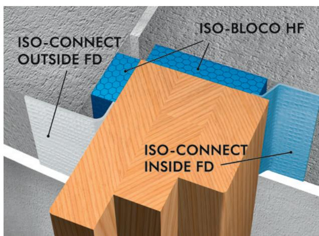
Ejemplo de instalación: SISTEMA DE SELLADO DE VENTANAS ISO<sup>3</sup>
