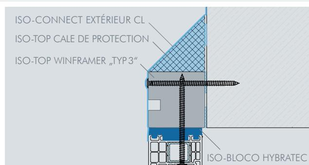
Exemple de mise en œuvre : ISO-TOP CALE DE PROTECTION
